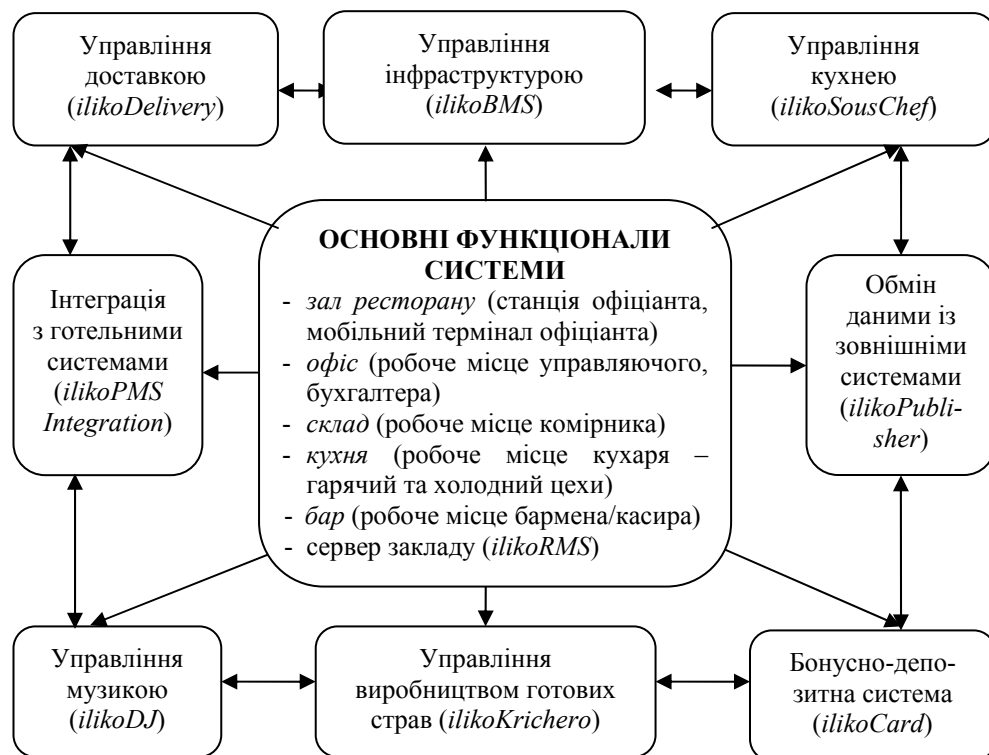
Рис. 5. Схема автоматизації системи управління на ЗРГ з використанням АСУ "ilikoRMS"
